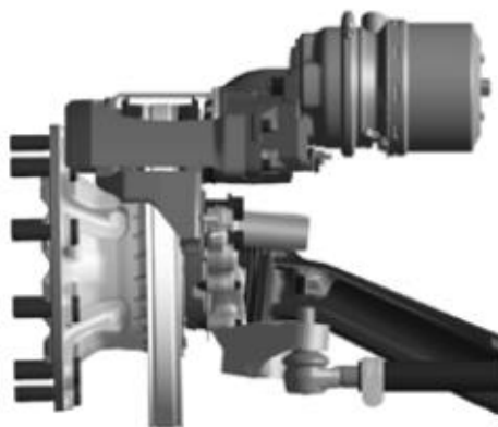
نمونه‌ای از نصب ترمز به صورت شعاعی
