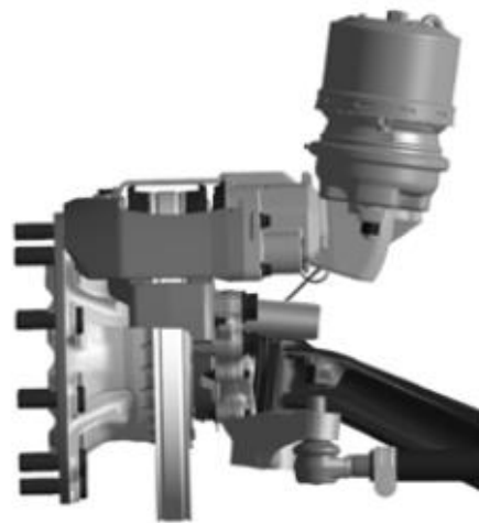
نمونه‌ای از نصب ترمز به صورت محوری
